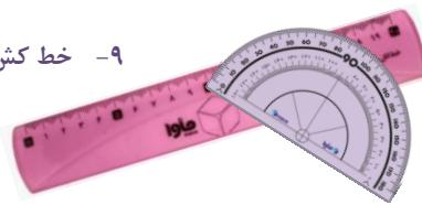
از خط کش برای اندازه گیری طول و از نقاله برای اندازه گیری زوایا استفاده می شود.
